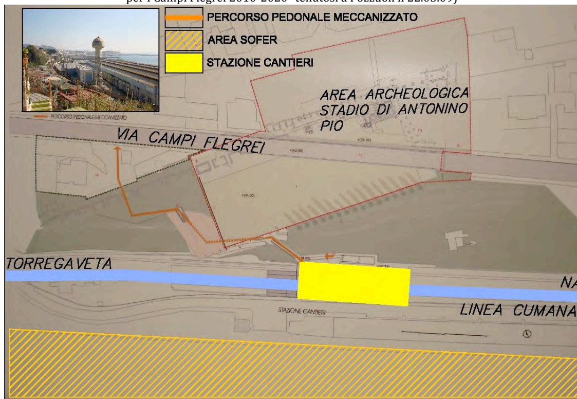
Figura 4. Infrastrutture ferroviarie: Progetto di adeguamento della Stazione Cantieri della linea cumana Napoli/Torregaveta. L'intervento prevede: un collegamento attraverso un percorso meccanizzato, che supera un salto di quota di 31 m s.l.m., con la parte alta della città in corrispondenza di Via Campi Flegrei e dello Stadio di Antonino Pio, secondo esempio di Stadio Romano in Italia, da qualche mese riportato alla luce; un varco del percorso meccanizzato, un sovrappasso carrabile su Via Campi Flegrei, ex-masseria centro di accoglienza ed espositivo (Fonte: materiale fotografico inerente alla mostra del Forum "Proposte e Obiettivi per I Campi Flegrei 2010-2020" tenutosi a Pozzuoli il 22.05.09)
